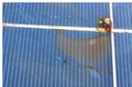
Verschroeiende solderingen van de busbars
