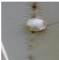
Blaas op achterzijde van een zonnepaneel
