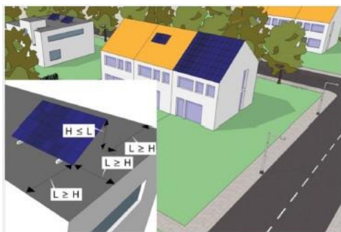
Een zonnecollector of zonnepaneel mag zonder vergunning geplaatst worden op een dak, waarbij de afstand tot de dakrand (L) groter moet zijn dan de hoogte (H).
