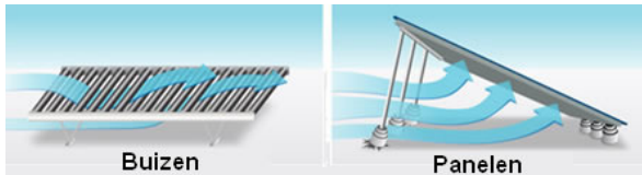
windlast: Vergelijking tussen buizen en panelen:
